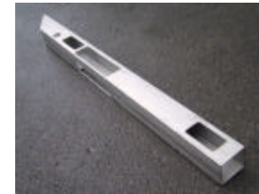
Öffnungen in Rechteckrohr
